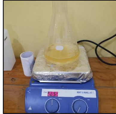
Pelarutan media MHA dengan hot plate
