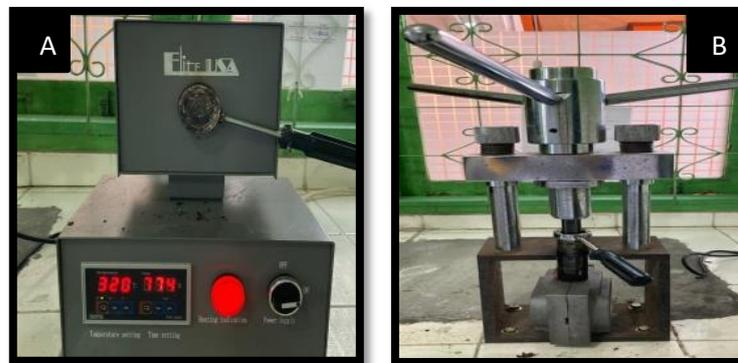
**Gambar 3.13** a) pemanasan bahan *nilon thermoplastik* b) proses *injection*
