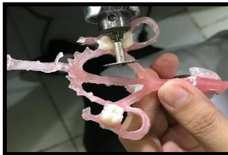
**Gambar 3.16** Pemotongan *Sprue*
