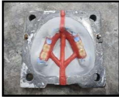
**Gambar 3.11** Pemasangan *Sprue*
