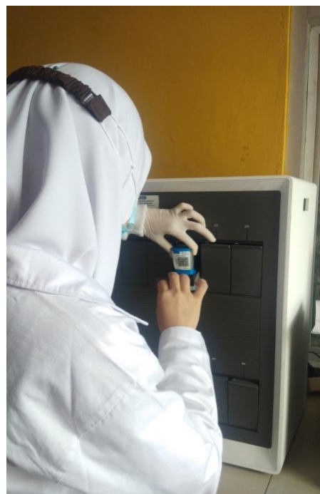
Gambar 10. Memasukkan katrid kedalam Alat GeneXpert dan menunggu hasil pemeriksaan
