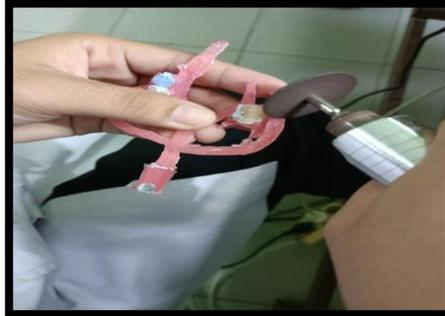
**Gambar 3.15** Pemotongan *sprue*
