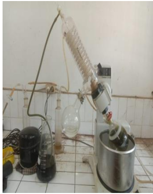
Gambar 29 Proses evaporasi maserat menggunakan rotary evaporator
