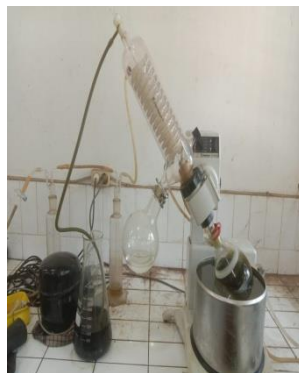
Gambar 24 Proses evaporasi maserat menggunakan rotary evaporator
