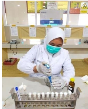
Gambar 37 Pemipetan aquades steril untuk pengenceran ekstrak
