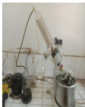
Gambar 34 Proses evaporasi maserat menggunakan rotary evaporator
