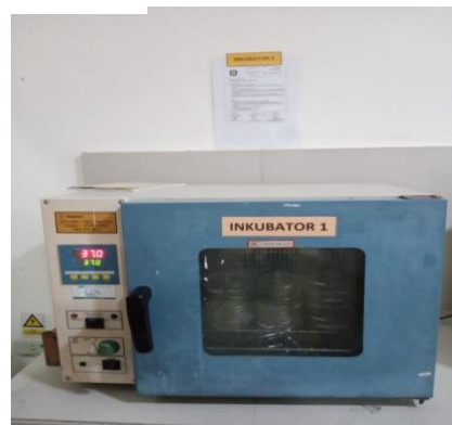
Gambar 43 Inkubasi pada suhu 37°C selama 24 jam
