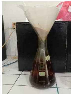
Gambar 22 Proses penyaringan endapan dan filtrat
