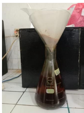
Gambar 27 Proses penyaringan endapan dan filtrat
