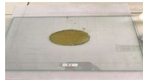
Uji Daya Sebar
