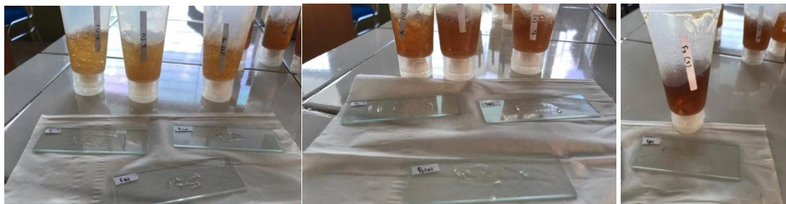
Pengujian homogenitas pada F1, F2 dan F3
