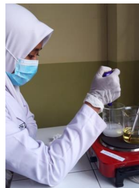
Mengaduk campuran minyak dan KOH hingga terbentuk pasta sabun
