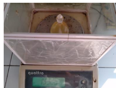
Menimbang piknometer + sabun dan piknometer + aquades
