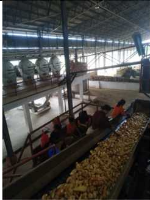
Pengangkutan singkong bersih menuju mesin pencacahan oleh belt conveyor
