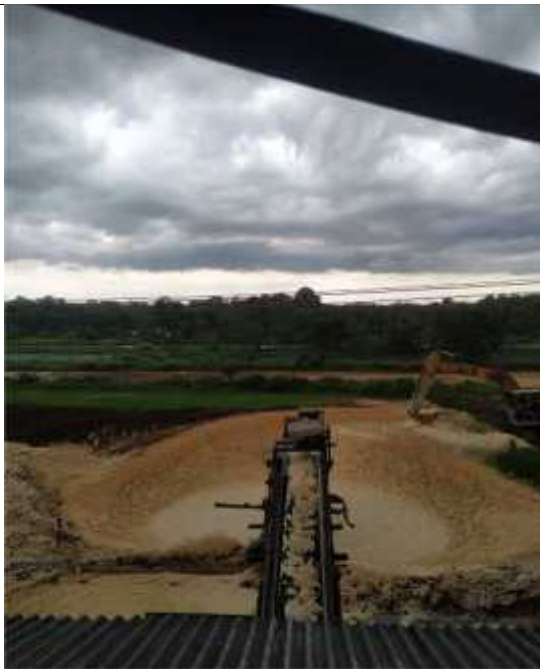
Belt conveyor pengangkut ongkok menuju tempat penampungan sementara
