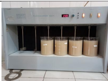
Proses pengadukan dengan flokulator
