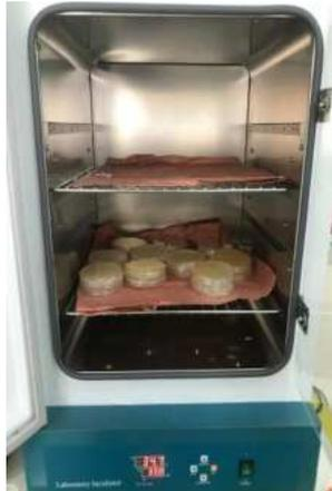
Gambar 11 Inkubasi sampel pada inkubator suhu 30°C
