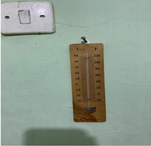
Termometer untuk mengukur suhu ruangan
