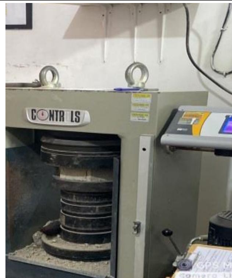
Proses Uji Kuat Tekan
