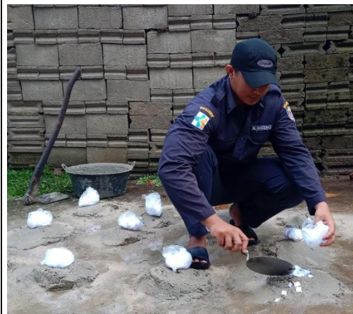
Proses Pencampuran Plastik
