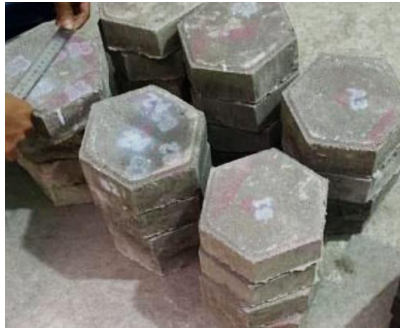
Pengukuran Paving Sebelum Uji Tekan
