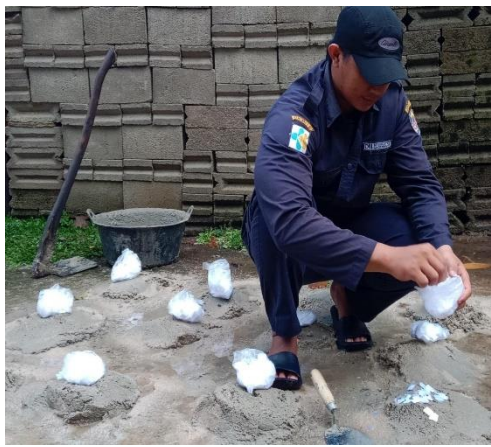
Proses Pencampuran Komposisi Plastik
