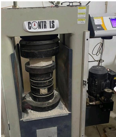
Proses Uji Kuat Tekan
