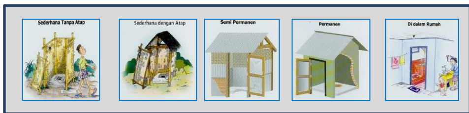
Gambar 2.2 Bangunan Atas Jamban
