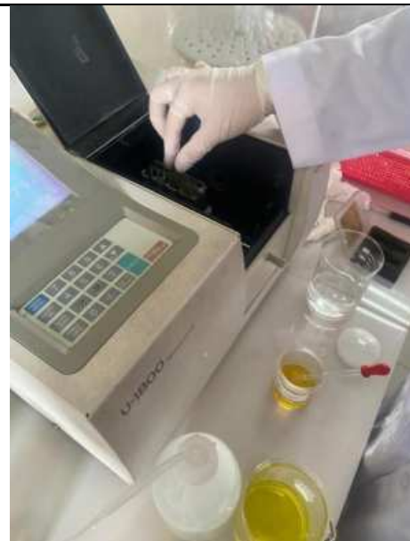
Pembacaan larutan seri dan sampel pada alat Spektrofotometer UV-Vis
