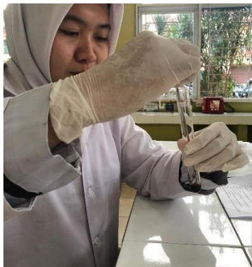
1. Diambil ekstrak daun kopi robusta sebanyak seujung spatula lalu masukan kedalam tabung reaksi.
