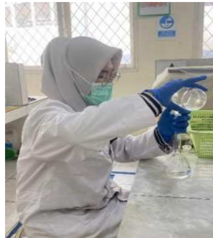
Gambar 4. Memindahkan larutan kedalam labu ukur
