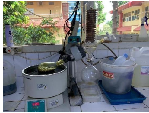
Gambar 12. Proses evaporasi menggunakan rotary evaporator
