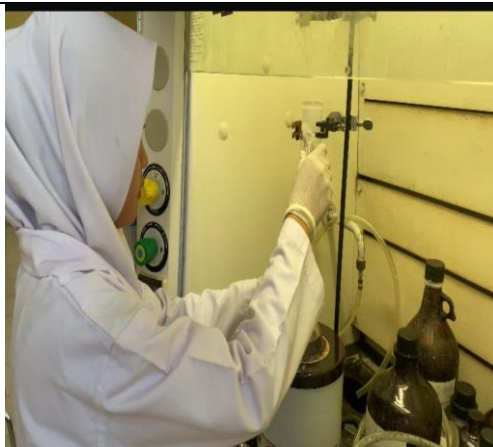
Perangkaian alat soxhletasi
