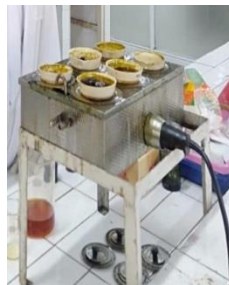
7. Pemekatan ekstrak Menggunakan waterbath
