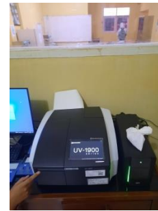
5. Proses membaca serapan larutan menggunakan spektrofotometri UV-Vis
