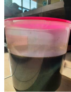
3. Perendaman serbuk simplisia dengan etanol 96% (Maserasi)
