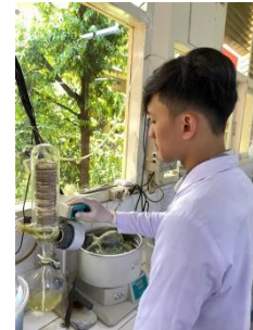
6. Proses pemekatan ekstrak daun kelor dengan menggunakan rotary evaporator
