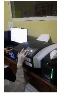
5. Proses membaca serapan larutan menggunakan spektrofotometri Uv-Vis
