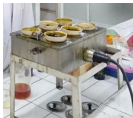
13. Proses pengentalan ekstrak menggunakan waterbath
