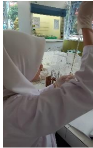
1. Proses memasukkan larutan sampel dan larutan standar ke tabung reaksi
