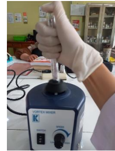
3. Proses menghomogenkan larutan dengan vortex
