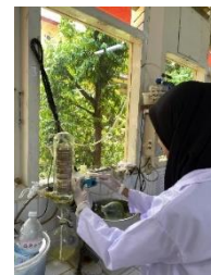
12. Proses pemekatan ekstrak menggunakan rotary evaporator
