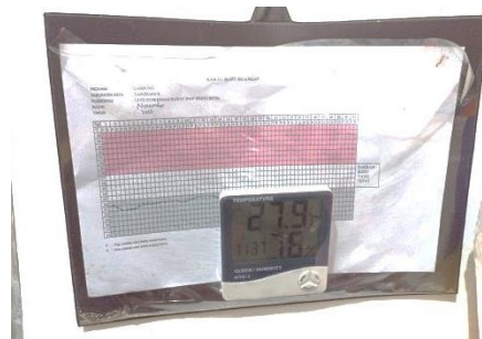
Terdapat pengukur suhu ruangan dan higrometer
