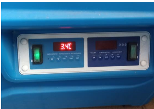
Vaksin dan serum disimpan dalam lemari pendingin (4-8°C) dan dipantau suhunya lalu dicatat
