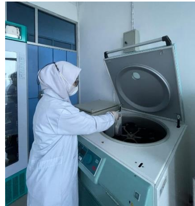
Melakukan proses centrifuge (5000 xG, suhu 4°C selama 5 menit)
