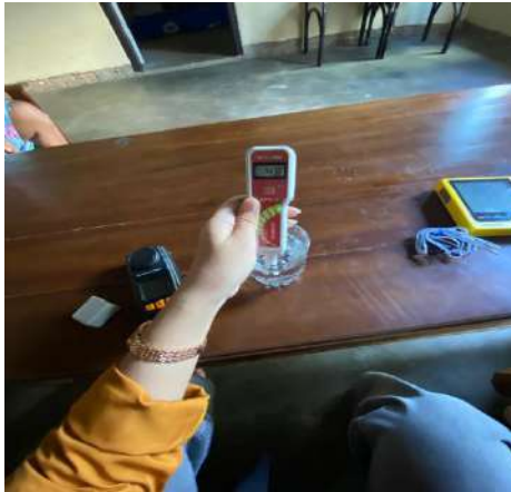
Pengecekan Ph pada air bersih
