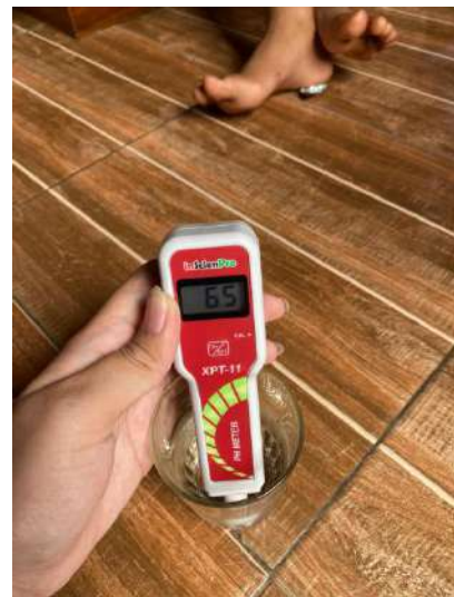
Pengecekan Ph pada air bersih
