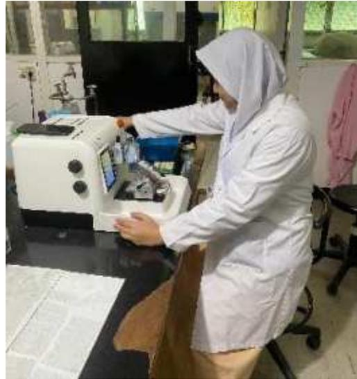
Gambar 8. Proses Pemotongan Blok pada mikrotom
