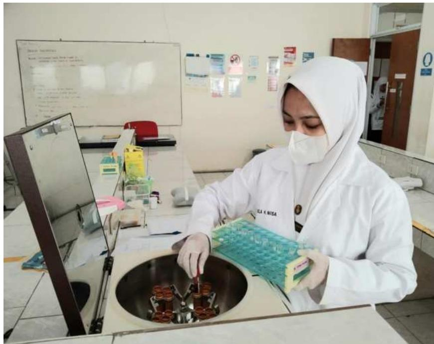
4. Melakukan centrifuge selama 15 menit dengan kecepatan 3000 rpm
