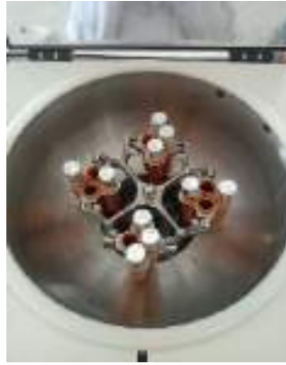
Sentrifuge selama 2 menit dengan kecepatan 3000 rpm
