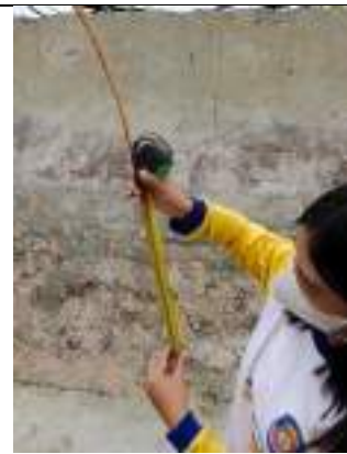
Pengukuran kedalaman air dengan meteran.
