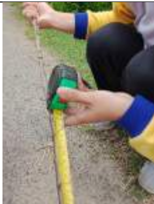
Pengukuran kedalaman air dengan meteran.
