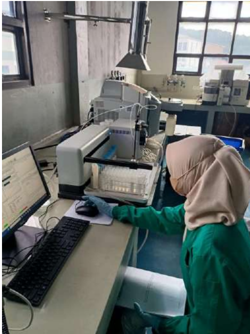
Pemeriksaan Kandungan Fe dan Mn Menggunakan AAS ( Atomic Absorption Spectrofotometry )
