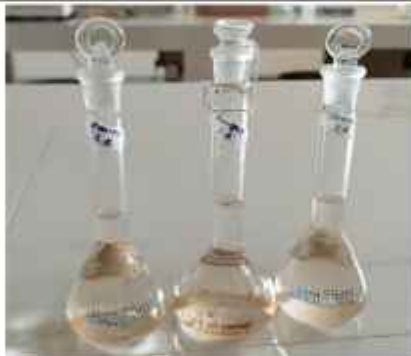
Gambar 37. Pada saat preparasi sampel, setelah sampel tersebut disaring kemudian ditambahkan dengan metanol didapatkan berwarna bening jernih atau tidak mengandung Rhodamin B.
