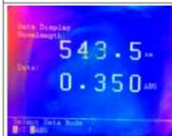
Gambar 27. Panjang gelombang dan absorbansi 0,6 ppm (1x pengulangan)
