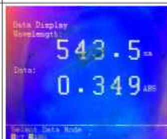
Gambar 29. Panjang gelombang dan absorbansi 0,6 ppm (3x pengulangan)
