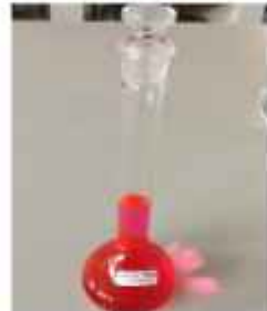
Gambar 5. Dimasukkan ke dalam Labu ukur (50 mL), dan dilarutkan dengan metanol sampai tanda batas
