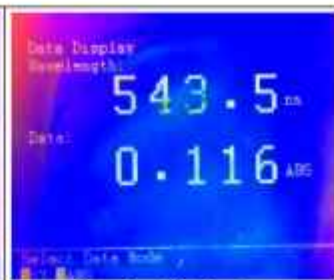
Gambar 23. Panjang gelombang dan absorbansi 0,2 ppm (3x pengulangan)
