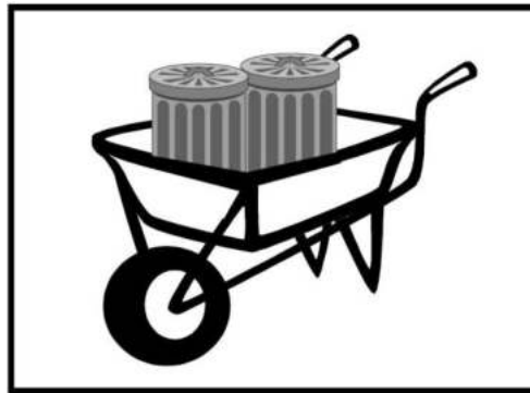
Gambar 2.3 Troli pengumpul dengan kapasitas 120-200 liter (bergantung ukuran wadah)
