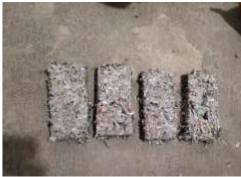
Hasil Pengeringan Paving Block Selama 21 Hari
