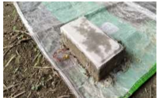
Hasil Pencetakan Paving Block Dengan Cacahan Plastik 45%
