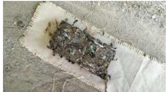
Hasil Pencetakan Paving Block Dengan Cacahan Plastik 100%
