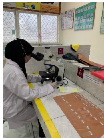
Gambar 3.6 Identifikasi sampel TDR pada mikroskop lensa objektif perbesaran 40X
