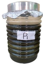
Gambar 48 Perendaman dengan etanol 70% dan pendiaman selama 72 jam
