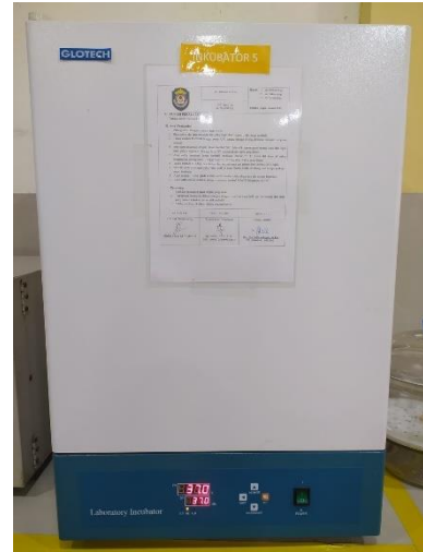
Gambar 74 Media diinkubasi pada suhu 37°C selama 24 jam
