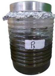
Gambar 62 Perendaman dengan etanol 70% dan pendiaman selama 72 jam
