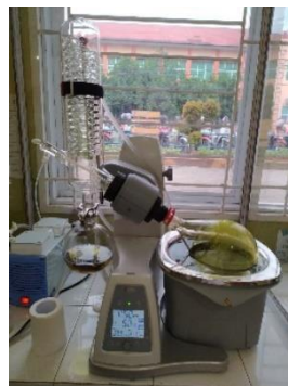
Gambar 51 Proses evaporasi dengan alat rotary evaporator Dlab XZ217AR000006
