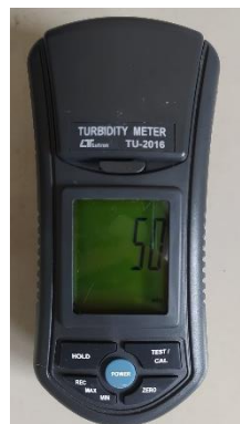
Gambar 70 Pengukuran kekeruhan suspensi bakteri Shigella dysenteriae
