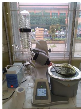
Gambar 65 Proses evaporasi dengan alat rotary evaporator Dlab XZ217AR000006
