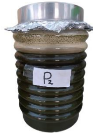
Gambar 55 Perendaman dengan etanol 70% dan pendiaman selama 72 jam
