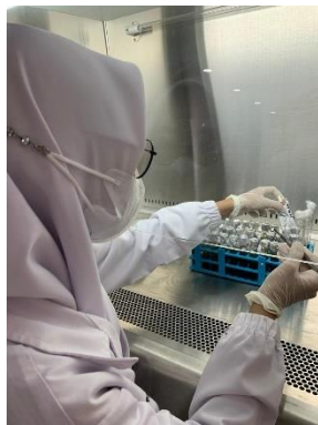
Gambar 71 Perendaman disk blank ke dalam larutan uji selama 15 menit
