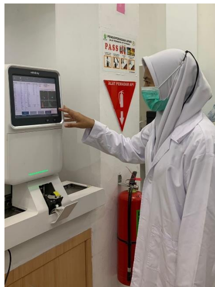
Penelitian di Instalasi Laboratorium Patologi Klinik untuk mengetahui cara kerja pemeriksaan hematologi rutin menggunakan Alat Mindray BC-6200
