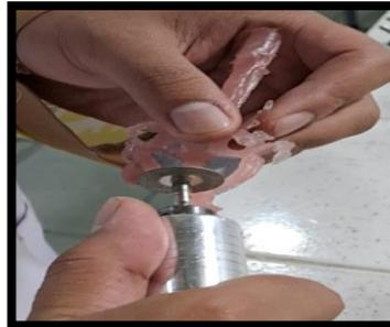
**Gambar 3. 14** Pemotongan *Sprue*
