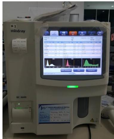
Gambar 4. Alat Hematologi Analyzer
