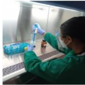
Gambar 10: Memipet NaOH 4% dan masukkan kedalam tabung tertutup
