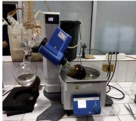
Gambar 12. Proses evaporasi menggunakan rotary evaporator
