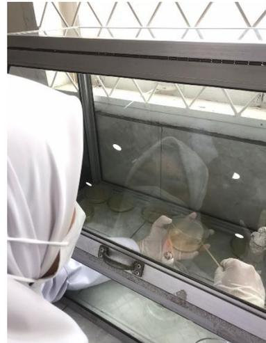
Gambar 23. Pemulasan suspensi jamur *Malassezia furfur* dengan lidi kapas steril pada media SDA
