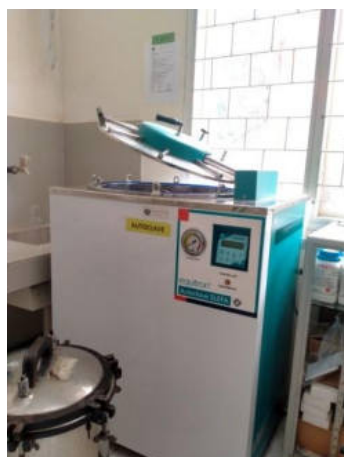
Media PDA disterilkan dalam autoclave
