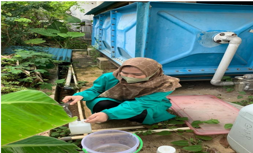
Pengambilan sampel air limbah pada outlet IPAL
