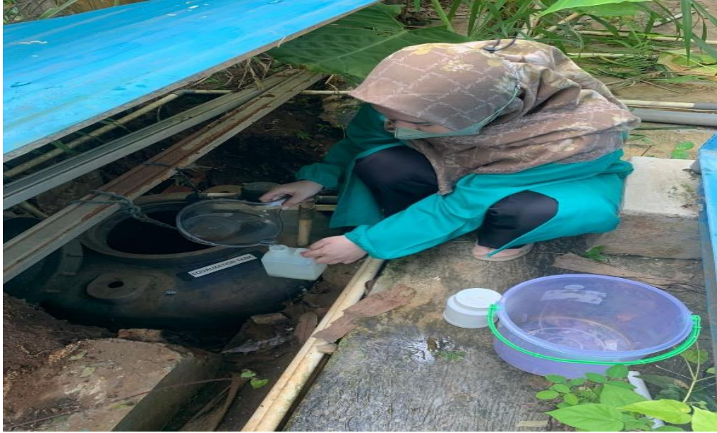
Pengambilan sampel air limbah pada Inlet IPAL
