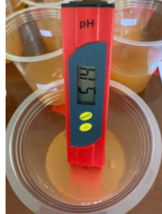
Pengukuran suhu dan pH pada masing-masing gelas uji
