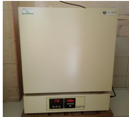
Proses sterilisasi dengan oven (suhu 160°C selama 1 jam)
