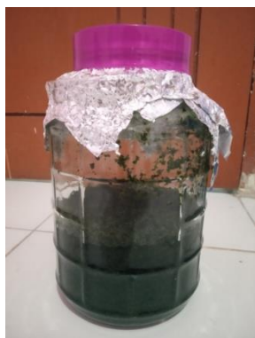
Proses remaserasi dengan etanol 96% sebanyak 1500 ml dan pendiaman selama 48 jam
