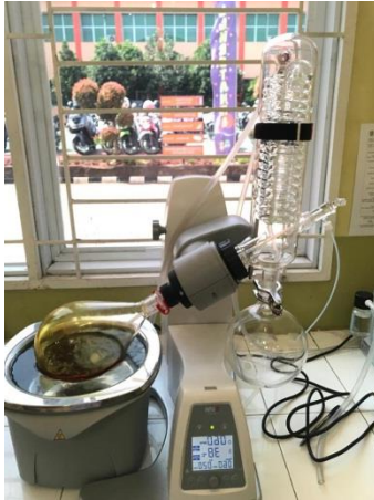
Hasil ekstrak cair dari soxhlet di rotary evaporator
