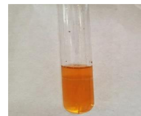
Hasil positif flavonoid terdapat perubahan warna jingga pada lapisan Amil Alkohol
