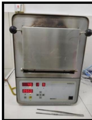
**Gambar 3.18** Proses pembuangan pola malam dalam *burn out furnice*
