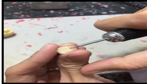
**Gambar 3. 10** Pembuatan retensi
