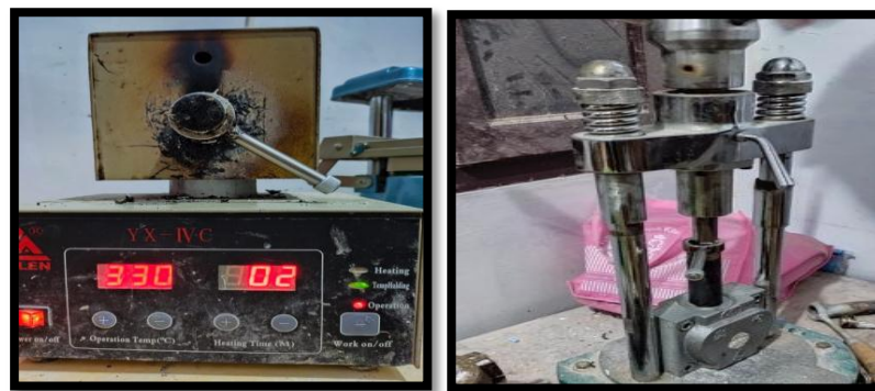
A. B. Gambar 3.15 Proses Injection (a). proses pemanasan (b). Injection
